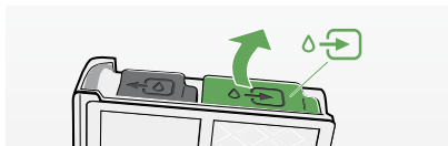
Obr. 3.5 Otevření nádržky čisté vody
